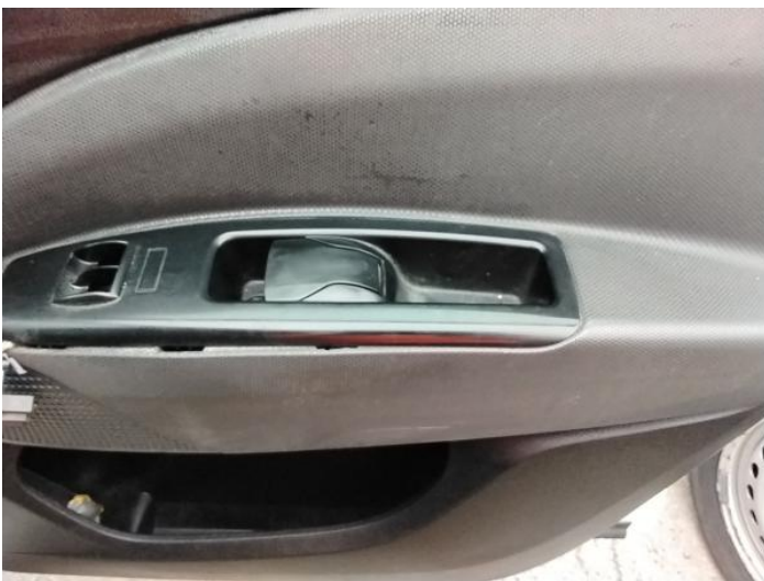
13: Door Pad osf Broken Replace
